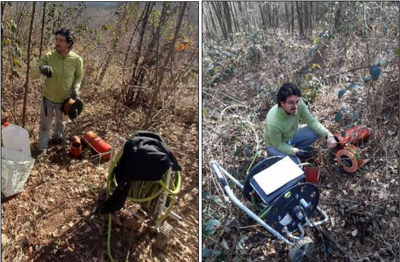
Figura 15: immagini fotografiche delle prove di emungimento sui piezometri in sito, immagine a sinistra S1 e a destra S2.
