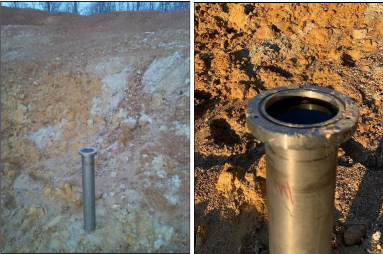
Figura 11: immagini fotografiche del permeametro di tipo Boutwell installato nell'area Rolleja.
